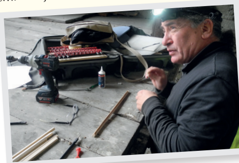
Der Dendrochronologe Raymond Kotic an der Arbeit. Vor ihm liegt ein Bohrkern, den er mit einem Hohlbohrer aus einem Bodenbalken des Luegislandturms entnommen hat.
